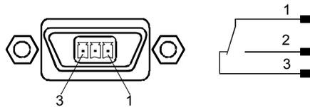
*Fig. 48: Relay 1, Relay 2*
