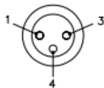
Figura 6: Ubicación de las clavijas en los conectores de los accesorios
